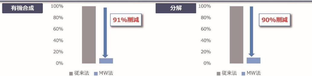
CO<sub>2</sub>排出削減効果は、①エネルギー消費量、②使用するエネルギー源という2つの要素のかけ算で決まる。マイクロ波を用いると多くの反応において消費エネルギーが減少する。さらに、カーボンニュートラルの流れにおいて、世界の化学メーカーは現行の化石燃料を大幅縮小、自然エネルギーを使うことを前提としてロードマップを描いており、エネルギー源のCO<sub>2</sub>排出原単位も小さくなる。
