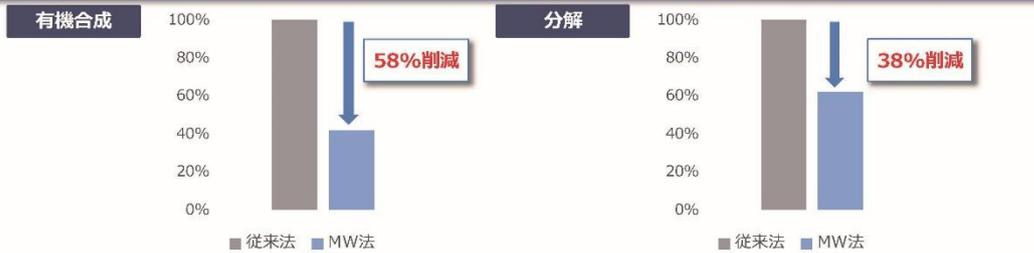
マイクロ波法活用によるCO<sub>2</sub>排出量削減実績：① マイクロ波によるエネルギー当量削減効果 × ② エネルギー源ごとのCO<sub>2</sub>排出原単位
