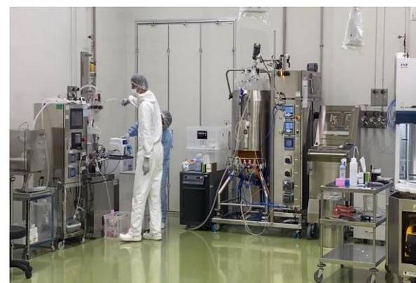
図：開発した装置で草津集中研にてベクターの製造を行っている風景
