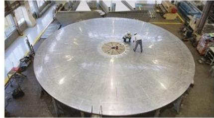
世界最大直径20mの製麹装置
