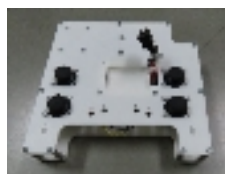
写真14 パテントコンテストへの応募作品の製作（スクミリンゴガイの捕獲無線ロボット無線操作装置）
