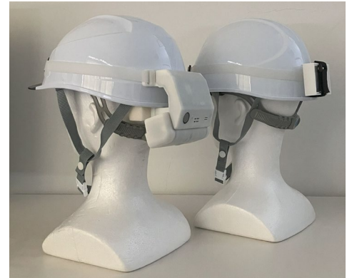
同社の熱中症リスク検出機器。 現在は建築現場の作業者の利用を想定し、ヘルメット型のデバイスとなっている。
